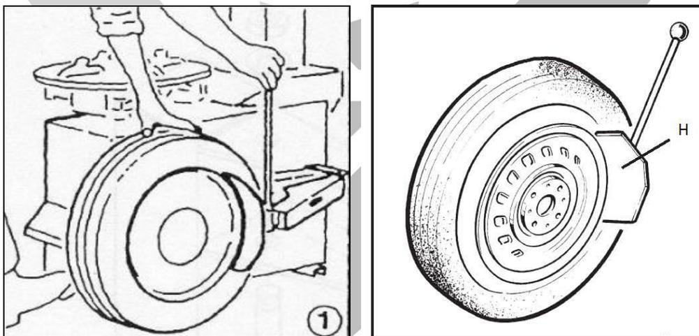
**CUIDADO! Quando o pedal é acionado, o braço oscila rápido e vigorosamente, e qualquer objeto dentro do alcance móvel do braço corre o risco de ser esmagado, inclusive partes de seu corpo como mãos e braços.**
