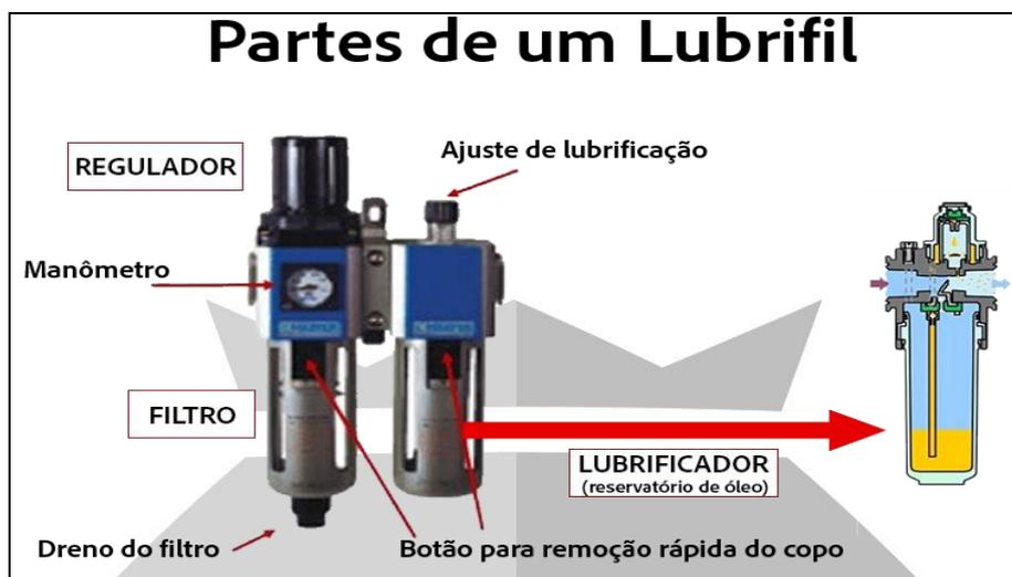
Mesmo com a aplicação do Lubrifil, é **obrigatório** que o equipamento seja instalado utilizando-se uma rede pneumática seca, livre de sujeira e umidade. É de suma importância que sejam instalados purgadores, tendo assim a garantia da purificação e qualidade do ar.
