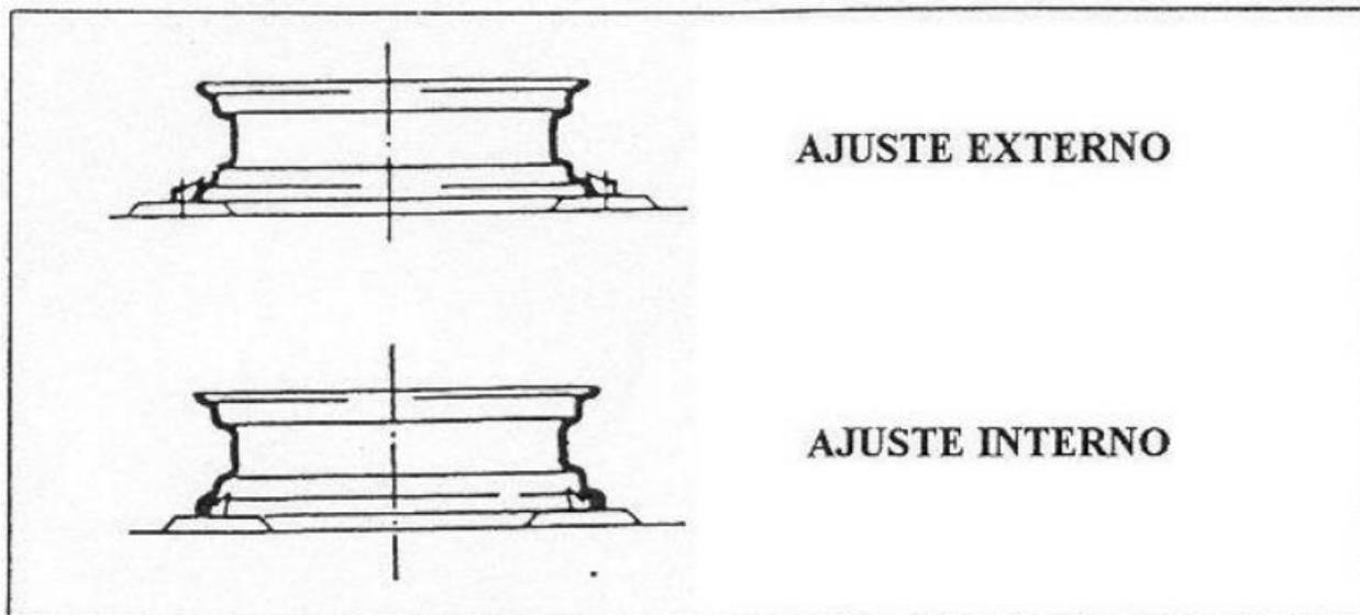
Para maior proteção às rodas de alumínio e ligas leves, use sempre, para esses tipos de rodas, o ajuste externo. Para rodas de aço, escolha entre os dois sistemas em função do tamanho da roda ou de sua preferência pessoal.
