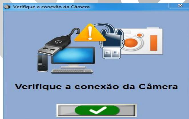
Ao aparecer esta mensagem verifique a conexão dos cabos USB no CPU e na torre do alinhador. Caso persistir o problema o cliente deve entrar em contato com o suporte técnico da MGFER.
