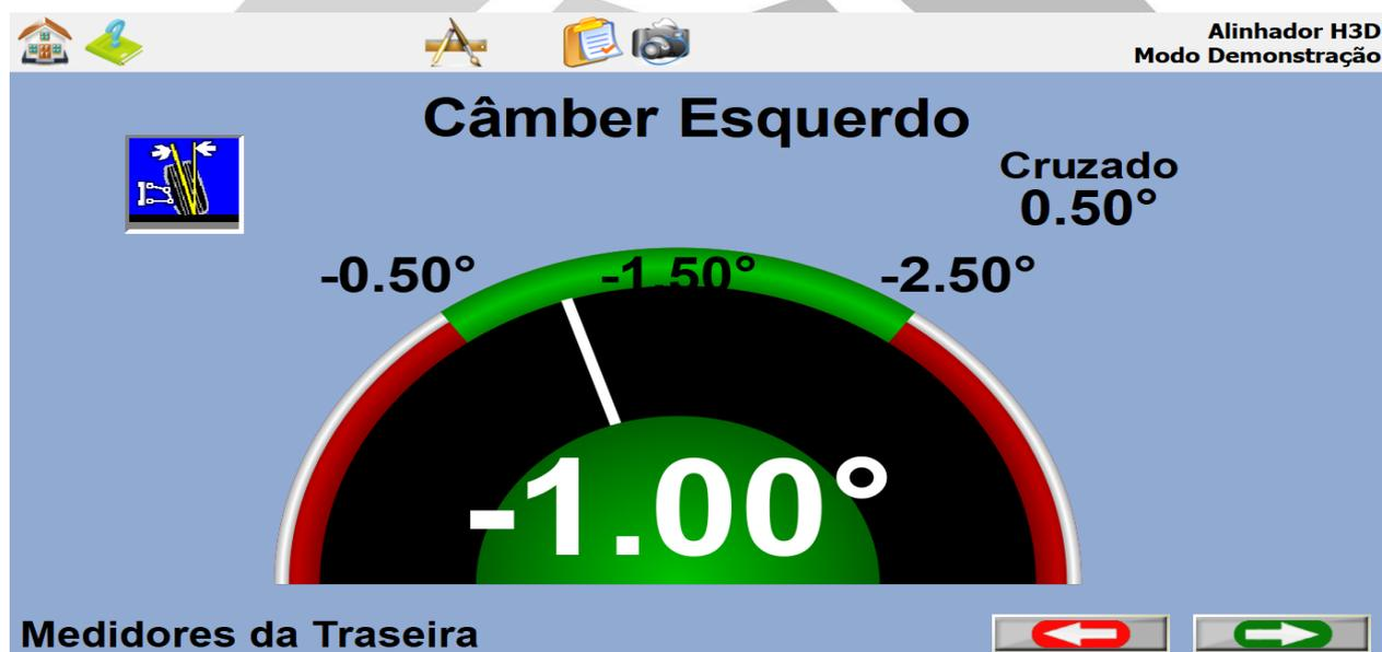
O nome do ângulo é exibido na parte superior da tela, com três dados na linha média representando o valor de especificação do veículo, e a medição real exibida na parte inferior, que varia de acordo com o ajuste do técnico até que o ponteiro amarelo entre na área verde média, indicando o final do ajuste do ângulo. Clique no botão OK para retornar à tela de leitura da roda traseira.
