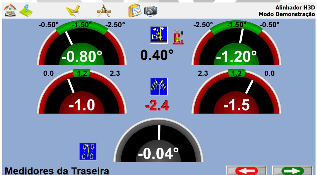
Esta tela exibe as medições dos ângulos nos formatos numérico e em mostradores e informações que determinam se serão necessárias correções. A exibição é dividida em três
